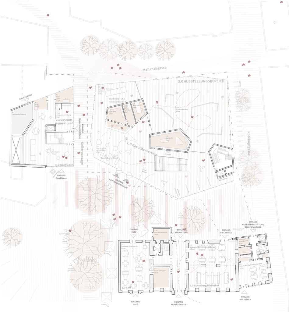
Grundriss Erdgeschoss | M 1 : 200
